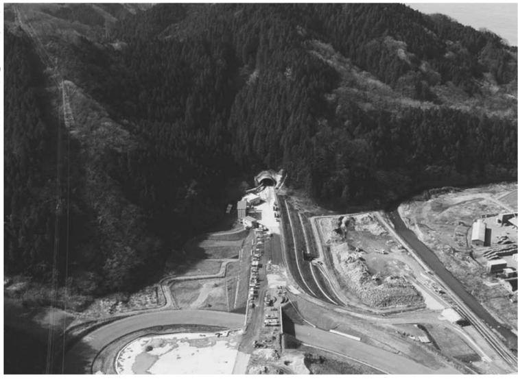
現在、初弾工事となる大岩川トンネルの掘削を進めており、本年度第4四半期に山形県側では最長となる延長1242.2mの鼠ヶ関トンネルの工事を発注する見通しだ。また、鼠ヶ関川橋は橋台2基の設置が完了し、橋脚工を進めている。
