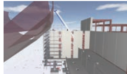
▲BIM化によるクレーン作業の確認
