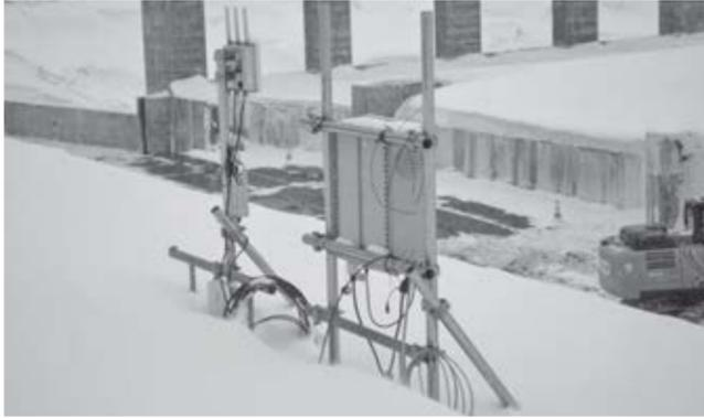
▲手前のボックス内に、板状(30cm四方程度)の5Gのアンテナが設置されている
