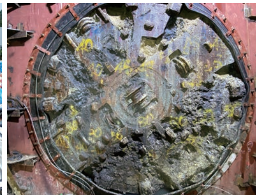
地中から出てきた巨石（左）と岩塊多く地層により削れたカッターヘッドの面板（上）
