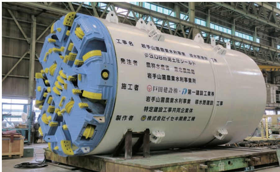
巨石切削を想定しローラーカッターを装備したシールドマシン
