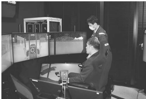
と、設備などを充実させている。広い敷地内では、遠隔操作するバックホウの操縦、ドローンの操縦といった技術習得が可能になっている。3D-CADの研修をはじめ、シミュレーターを活用した重機オペレーターの育成、遠隔現場の実用性なども体感できる。
