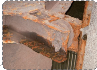
▲シリンダーゲート ガイドローラの脱落
